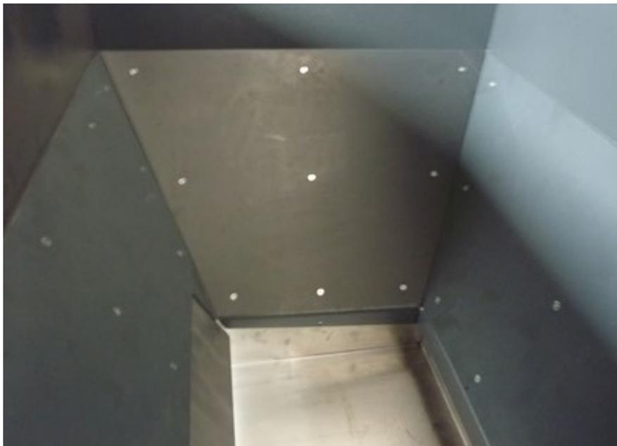
Il permet de protéger la trémie en cas de basculement de pièces lourdes. Il peut être fourni en tôle d'acier, en acier inox ou manganèse. Il est appliqué mécaniquement par l'intermédiaire de vis appropriées et il peut être facilement remplacé.
