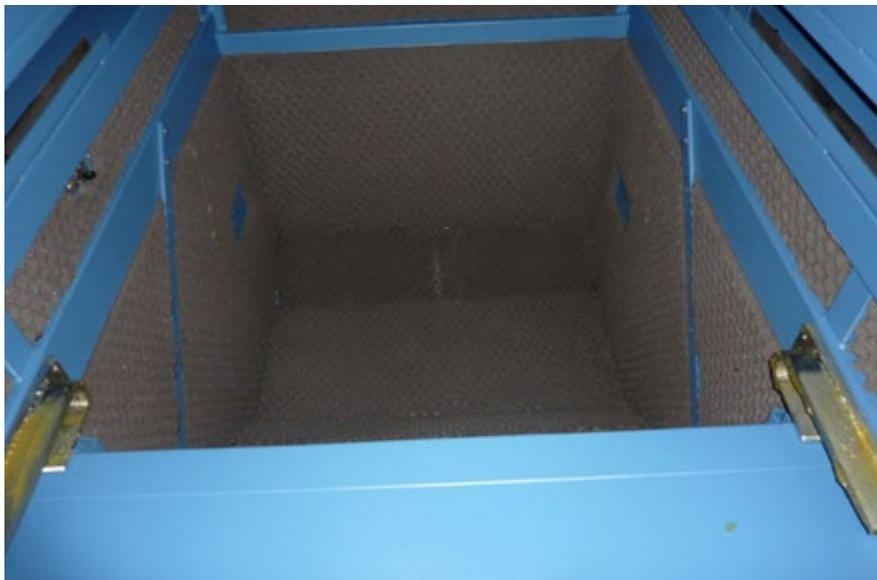
Elle est réalisée à l'aide d'une structure spéciale : des panneaux avec du matériel multicouche laminé. Le groupe hydraulique est intégré dans cette insonorisation. Elle permet dans la plupart des cas, ( et selon la typologie du produit traité), de maintenir le seuil du bruit moyen en dessous des 80 dB.
