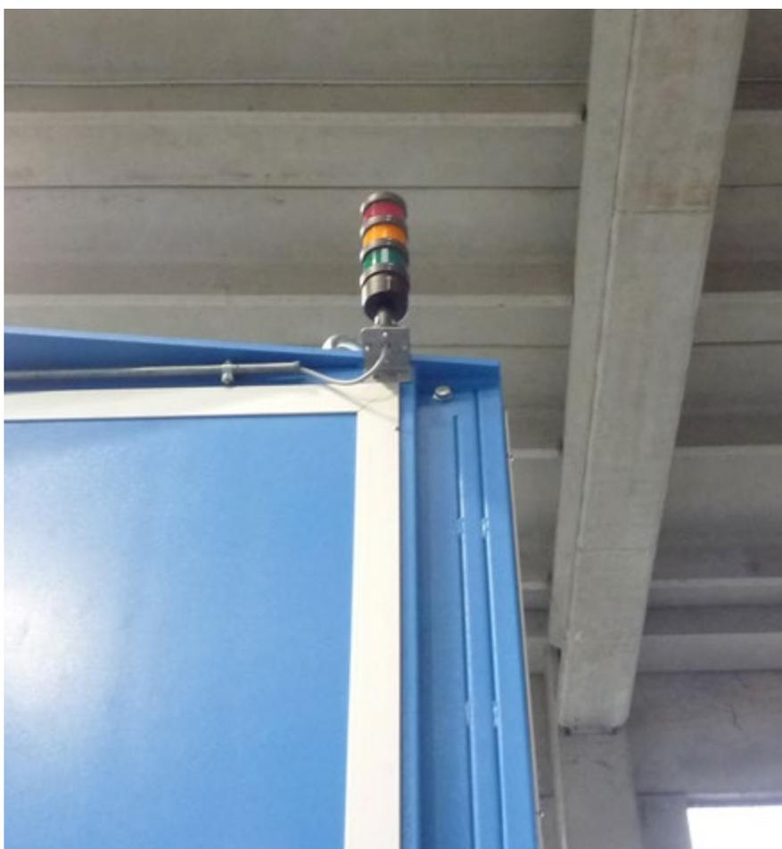
Elle permet de visualiser à distance l'état du basculeur, en avertissant au préalable s'il est nécessaire de changer la benne.
