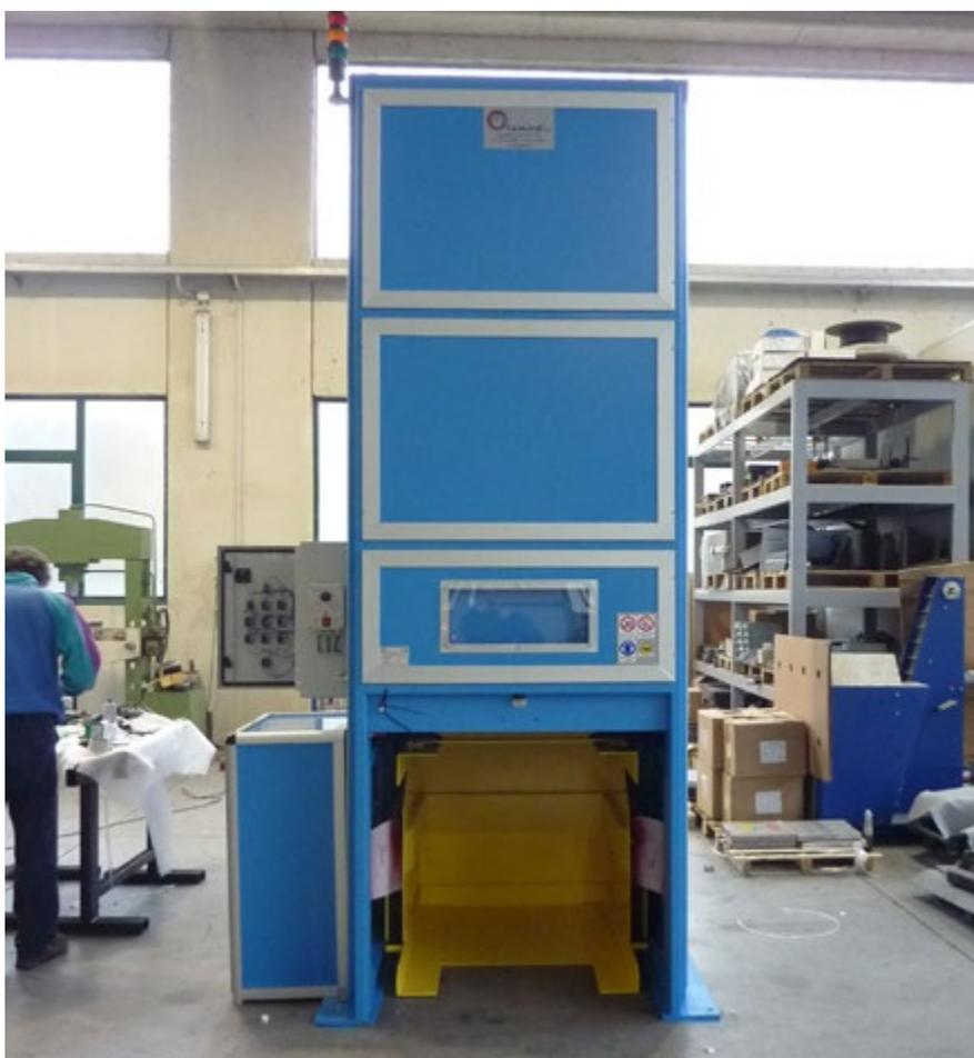
Elle est réalisée en appliquant à l'intérieur de la structure, une éponge phono-absorbante prévue à cet effet. Elle permet, dans la plupart des cas ( et selon la typologie du produit traité), de maintenir le seuil du bruit moyen en dessous des 85 dB.
