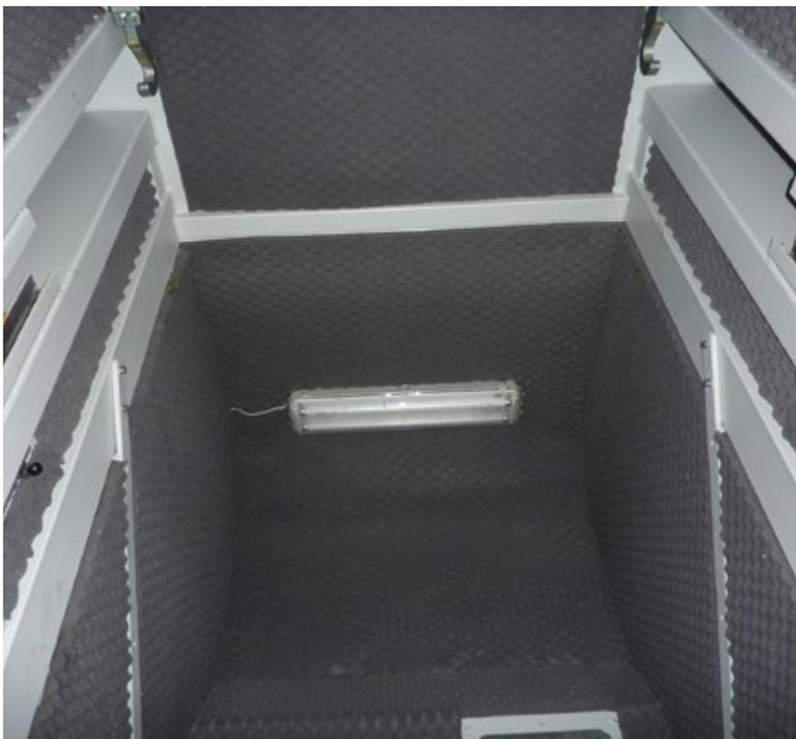
Elle permet d'améliorer les éventuelles inspections internes à l'aide des hublots prévus à cet effet durant le cycle automatique du basculeur. Elle peut être fournie avec un simple actionnement ON/OFF placé sur le cadre électrique, ou gérée avec une temporisation par PLC.
