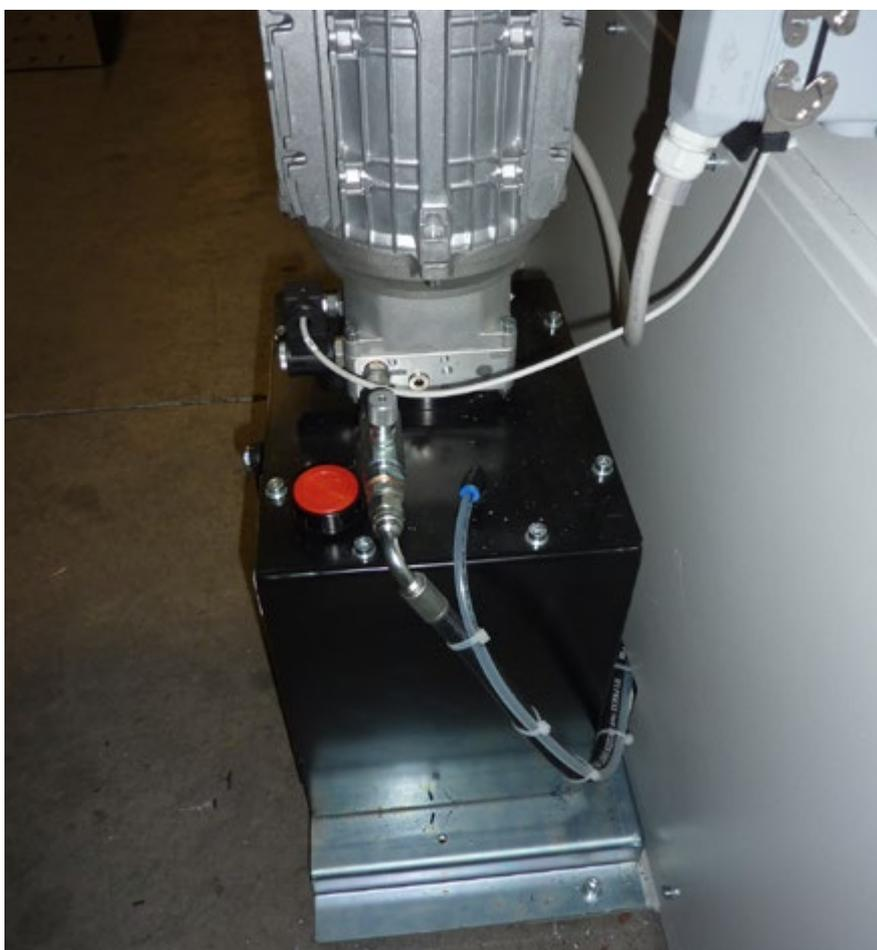
Utilisé pour diminuer le temps de changement de la benne, il permet d'augmenter la vitesse de soulèvement de la benne d'environ 50 % à la vitesse optimale avant d'effectuer le cycle de basculement.
