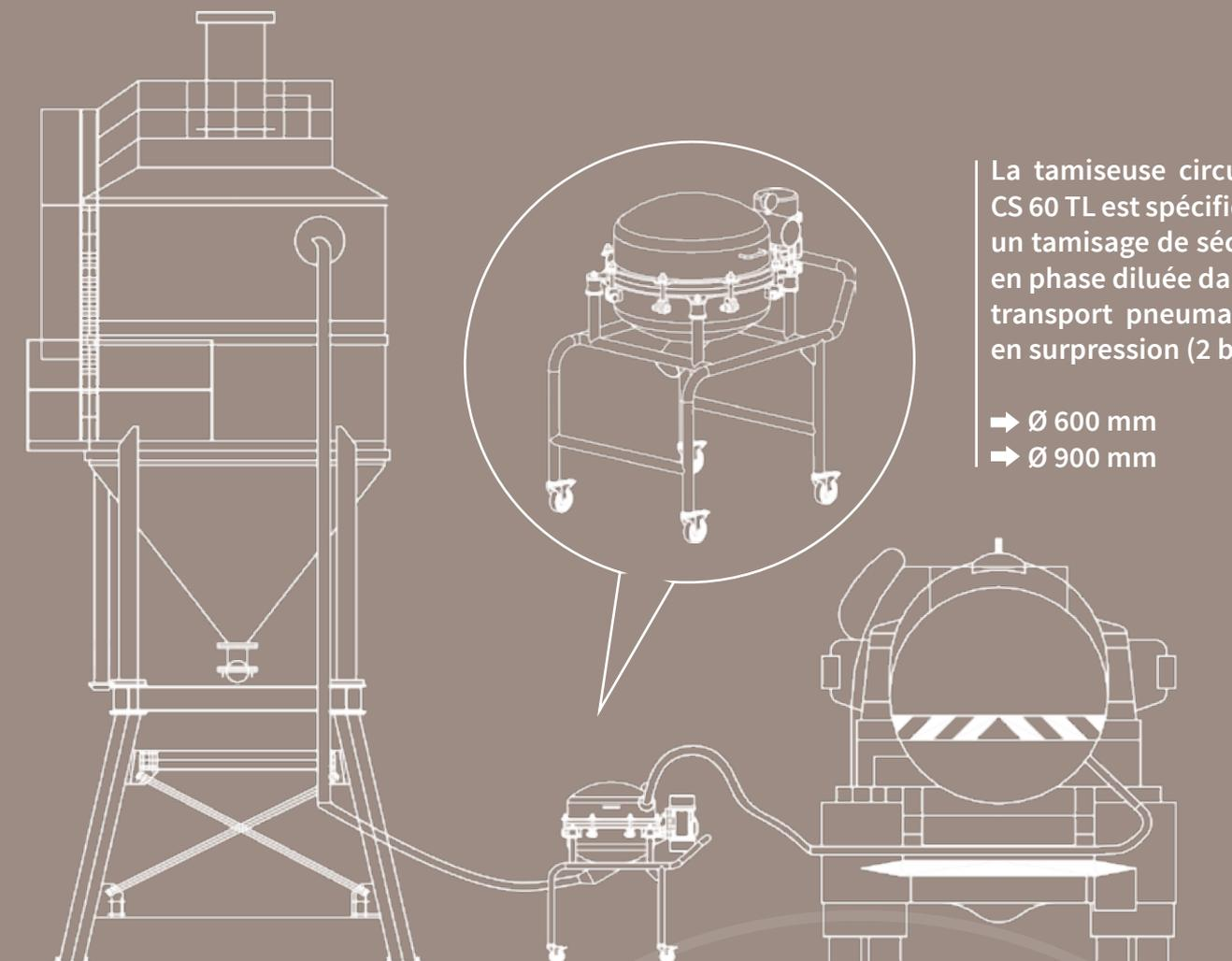
La tamiseuse circulaire CS 60 TL est spécifique à un tamisage de sécurité en phase diluée dans un transport pneumatique en surpression (2 bars).
