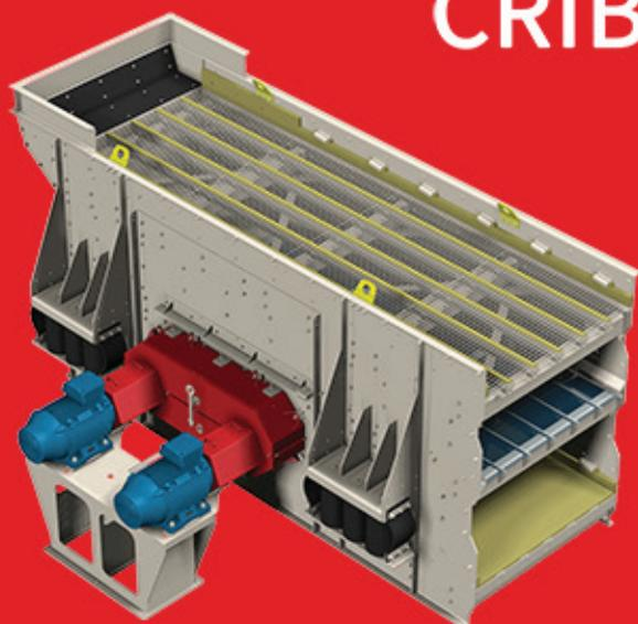
“ Le crible TRIROL® horizontal est prévu pour fonctionner jusqu'à 8 g d'accélération permettant de cribler les produits très difficiles et collants de 1 à 300 mm à sec ou sous arrosage. ”
